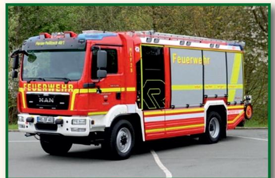
So ein HLF 20 (Hilfeleistungslöschgruppenfahrzeug 20) verfügt über einen 1.600 Liter fassenden Löschwassertank, 120 Liter Schaummittelvorrat und 12 kg Löschpulver. Seine Feuerlöschkreiselpumpe kann pro Minute 2.000 Liter Wasser bei einem Ausgangsdruck von 10 bar fördern und kostet mit der entsprechenden Zusatzbeladung ca. 370.000 EUR!!!!
